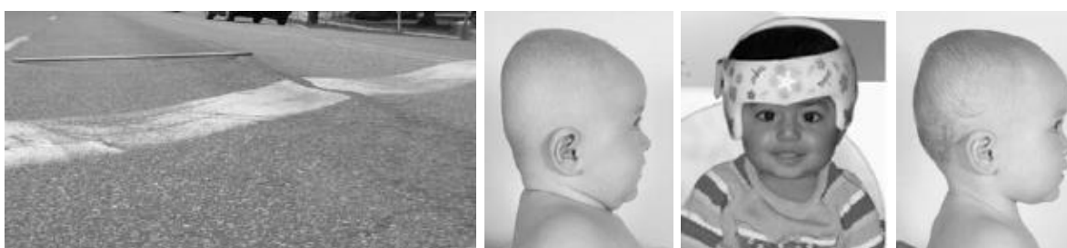
Obr. 21 Ukázky uplatnění tečení. Vlevo: vyježděné koleje v asfaltové vozovce vlivem postupující deformace provozem, vpravo: zotavení v lidských tkáních - dítě před a po léčbě přilbou (převzato z Lakes 2009).
